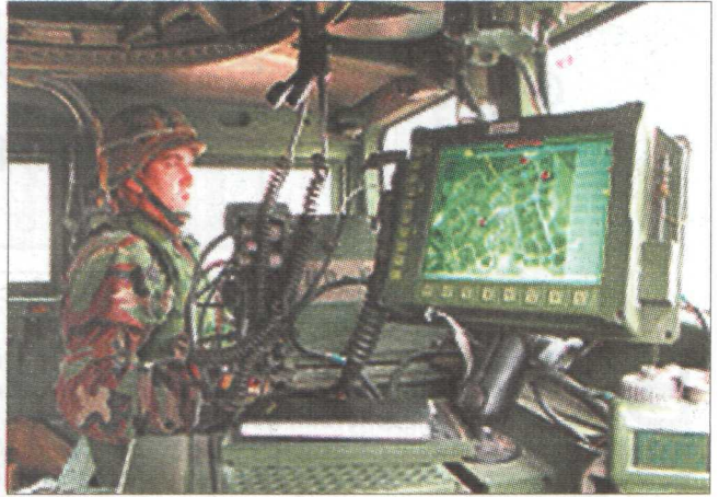
Терминал АСУ FBCB2 с отображением единой картины тактической обстановки, установленный в машине управления командира роты боевой бригадной группы сухопутных войск США
