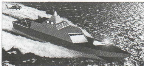
Рис. 8. Проектное изображение варианта корабля прибрежной зоны (LCS) с обводами корпуса типа глубокое V комбинации «Локхид-Мартин»
